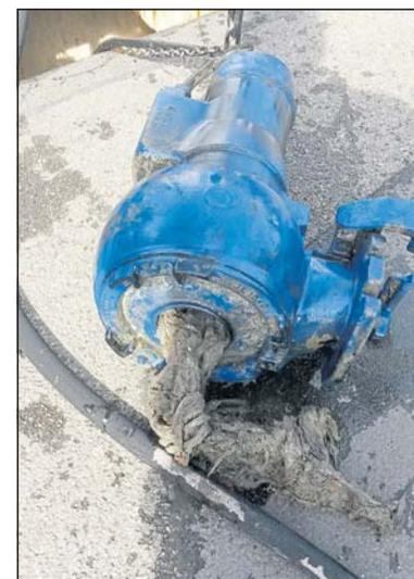
**Budenheim.** – Es ist erstaunlich, welche Gegenstände in den Kanal gelangen. Kürzlich musste im Hebewerk Geschwister-Scholl-Straße eine Abwasserpumpe in Stand gesetzt werden. Ursache war ein Wischmop, der die Pumpe lahm legte. Dies führt nicht nur zu einem höheren Unterhaltungsaufwand, sondern kann bei Starkregenereignissen auch zu erheblichen Überflutungen der Straßen führen, wenn in diesem Moment die Pumpenleistung ausfällt.
