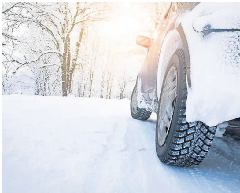
Gesetzlich vorgeschrieben ist eine Mindestprofiltiefe von 1,6 Millimetern. (Foto: Shutterstock)
