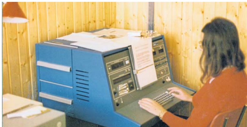
Unisetter Lichtsatzmaschinen des Herstellers Compugraphic kamen zunächst im „Rheingau Echo“ zum Einsatz. Die Erfassung der vielen Manuskripte erforderte einen großen Personaleinsatz.
